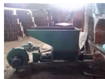
Sistema de alimentación de combustible tipo STOKER
