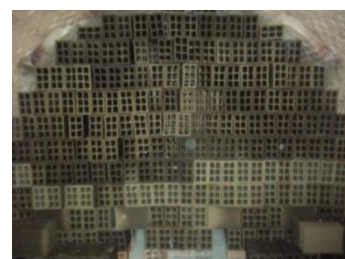
Endague horno – cargue del material cerámico crudo en el área de quema
